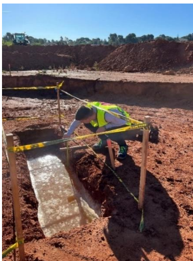
3° Medida de la evolución del calado en la zanja.
